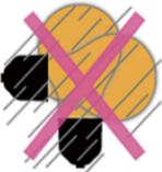
・防水ソケットは必ず下向きに使用して下さい。雨水がソケット内に侵入するため、上向き・横向き使用はできません。<感電、発火、破損の危険性>
